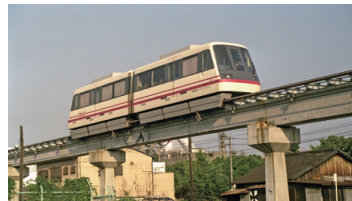
HSSTの実験の様子。公共交通機関として実用化するために走行実験が行われた。
