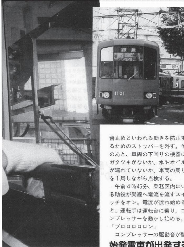
歯止めといわれる動きを防止するためのストッパーを外す。そのあと、車両の下回りの機器にガツキがないか、水やオイルが漏れていないか、車両の周りを1周しながら点検する。
