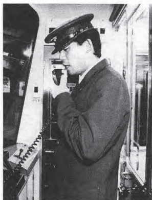
出庫点検が終了すると、無線を使い基地局へ連絡を行う。
