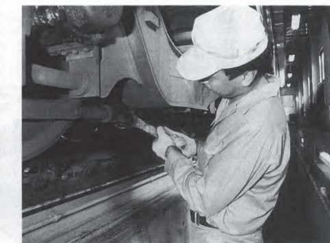
ブレーキの調節は、安全な運転を左右する重要な点検項目のひとつだ。
